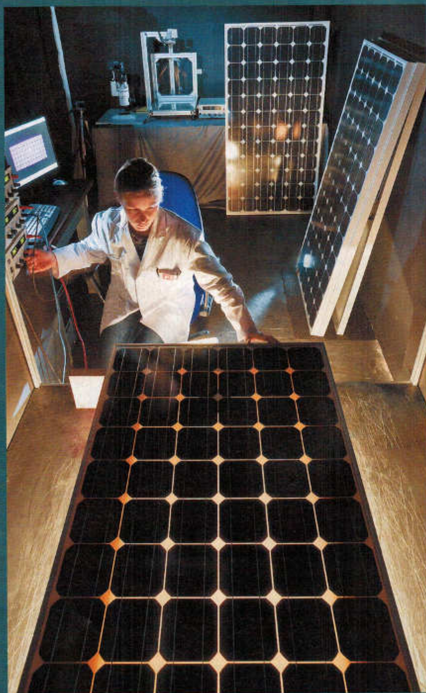
Auf dem Prüfstand: Für eine Elektrolumineszenzaufnahme wird ein Solarmodul bestromt. Das Leuchten der Zellen ist für das menschliche Auge allerdings unsichtbar.
